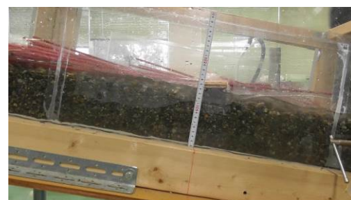
写真-1 水理実験における流木捕捉状況 (上：勾配約 5 度、下：約 11 度)
