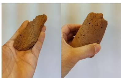
図-5 試験焼成した多孔体
