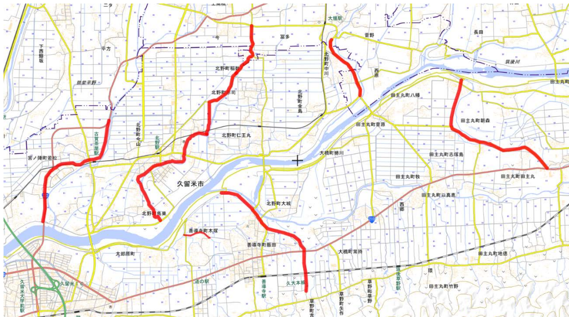
図 1 1 : 筑後川中流域の支川の現存する片側堤防(地理院地図を加工)
