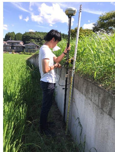
図7：氾濫痕跡の測量
