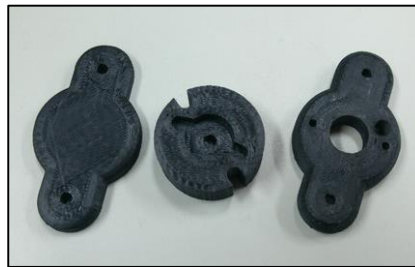
図11 3Dプリンタ [5][11] によって製作した治具とモータ
