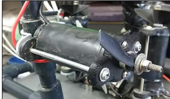
図12 改良後に取付けた水中モータ
